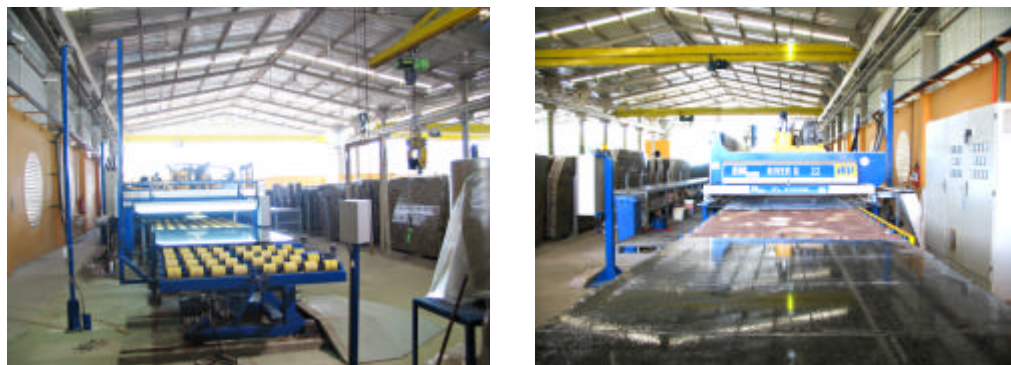
Figura 6 – Politrizes multicabeças em funcionamento na empresa Santo Antonio Mármore e Granito Ltda (Cachoeiro de Itapemirim-ES), fotografado pelo autor em 20/04/2004.
