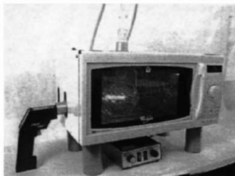
Figura 9. Adaptação de forno de microondas para reações fotoquímicas.
