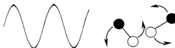
Figura 11. Modelo de estruturas dipolares tentando orientar seus dipolos com o campo elétrico das microondas.
