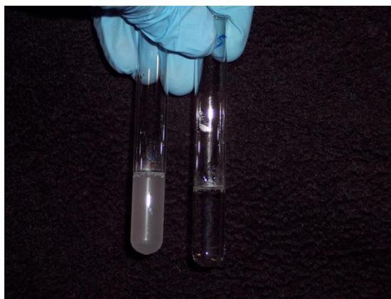
Figura 4.2 Diferença entre uma má suspensão dos nanocristais e uma boa suspensão dos nanocristais.
