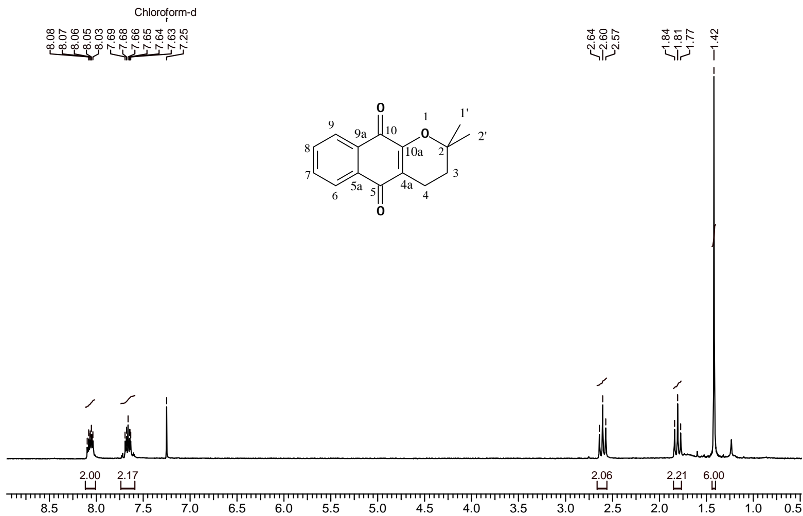
Espectro 11 – RMN ^1\text{H} (200 MHz) da \alpha -lapachona (2,2-dimetil-3,4-di-hidro-2H-benzo[g]cromeno-5,10-diona).
