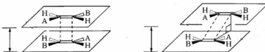
Figura 1.14. : Duas formas diferentes de como as ligações duplas de dois monômeros podem estar arranjadas no espaço.
