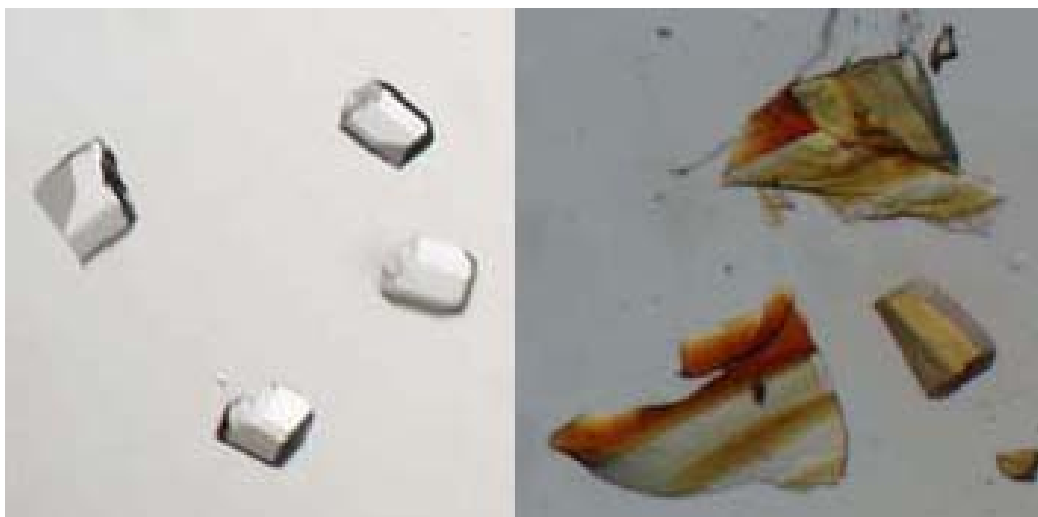
Figura 1.2: Exemplo de cristais de boa qualidade para a análise em difratômetro de monocristais , nos quais se observa faces bem definidas.
