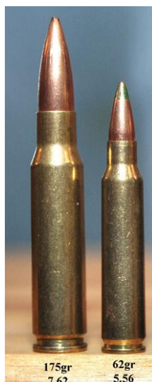
Figura 5 - Comparação entre os tamanhos das munições de calibre 7.62x51mm (à esquerda) e 5.56x45mm (à direita). Adaptado de Barbosa (2017).
