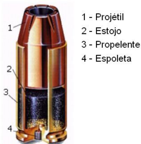
Figura 4 - Cartucho de munição e seus principais componentes. Adaptado de Sindespe (2014).
