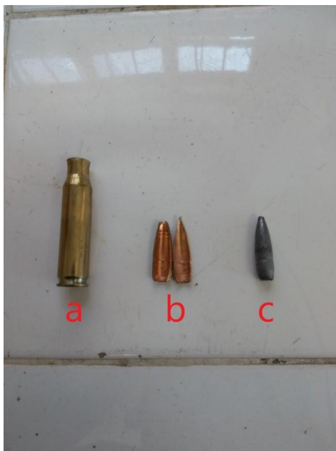
Figura 17 - Uma munição desmontada: (a) o estojo; (b) a capa de latão; (c) o núcleo de chumbo do projétil.
