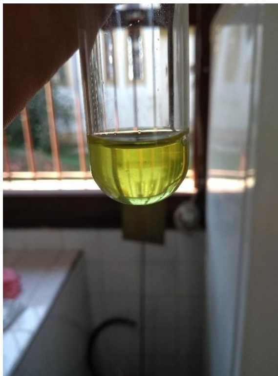
Figura 27 - Solução amarela obtida após a formação do complexo tetraiodoantimonato(III) devido à reação do iodeto com o \text{Sb}^{3+} da amostra, em meio ácido.
