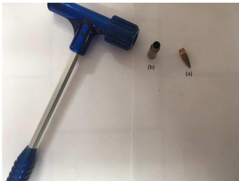
Figura 14 – Martelo de inércia utilizado para a remoção do projétil (a) do cartucho (b).
