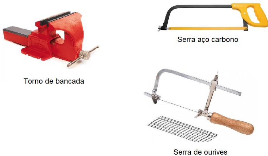
Figura 16 – Torno de bancada, serra de aço carbono e serra de ourives utilizados para extrair o núcleo de chumbo dos projéteis.
