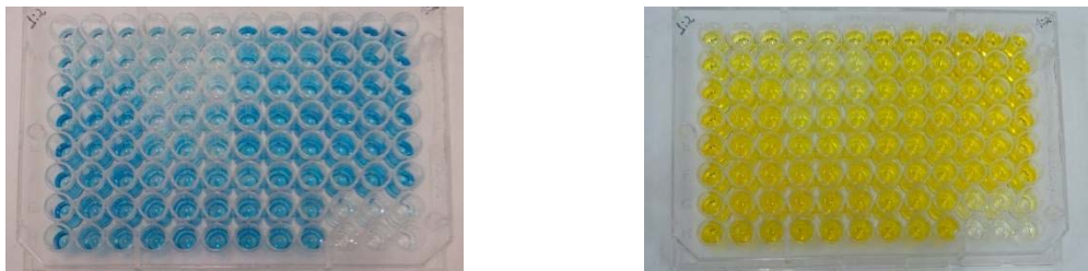
Figura 20: Placa após a adição de TMB (coloração azul) e placa após adição de ácido sulfúrico (coloração amarela)
