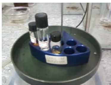
Figura 17: Reações realizadas em vials com tampa de rosca sob aquecimento.
