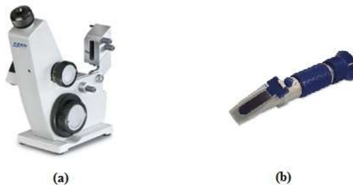
Figura 16. Refratômetros analógicos: (a) de bancada e (b) portátil (Fonte: www.medicaexpo.com ).
