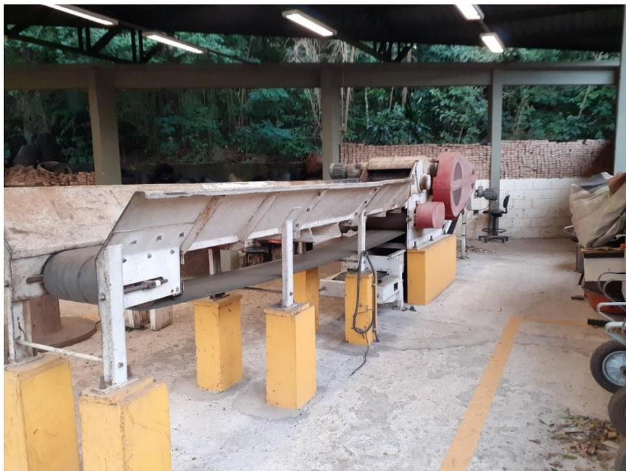
**Figura 8.** Triturador PBHC, modelo AFB1200. Fonte: própria autora.
