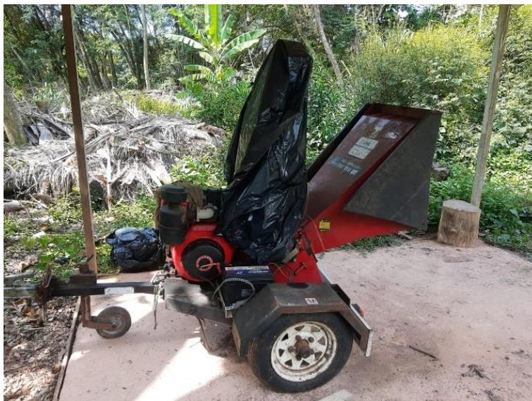
**Figura 7.** Bio-Triturador BIO 150DT LIPPEL, motor diesel, capacidade para galhos de 80 mm.
