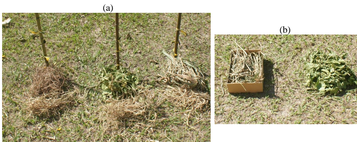
Figura 4: Amostras de acículas de pinus, feijão-de porco e capim-colonião para teste de inflamabilidade (a) e caixa utilizada para padronizar volume das amostras (b).
