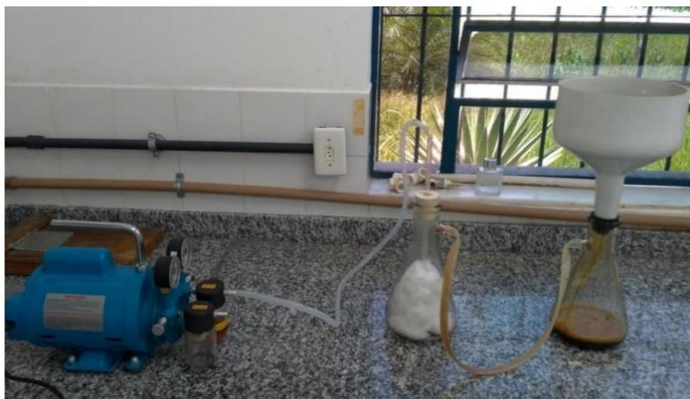
Figura 12: Aparato de filtração a vácuo utilizado para a etapa de obtenção da torta de lignina.
