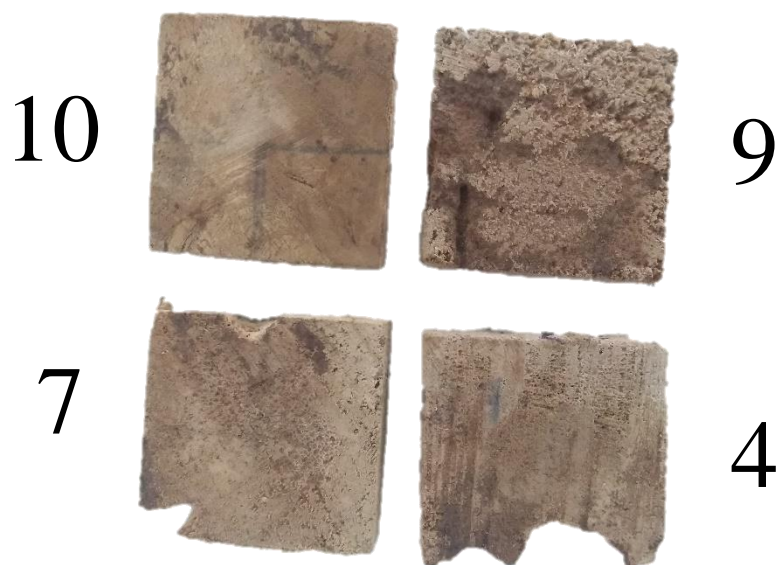
Figura 4. Exemplificação das notas atribuídas ao desgaste provocado por Nasutitermes macrocephalus nos corpos-de-prova da madeira de Hevea brasiliensis .
