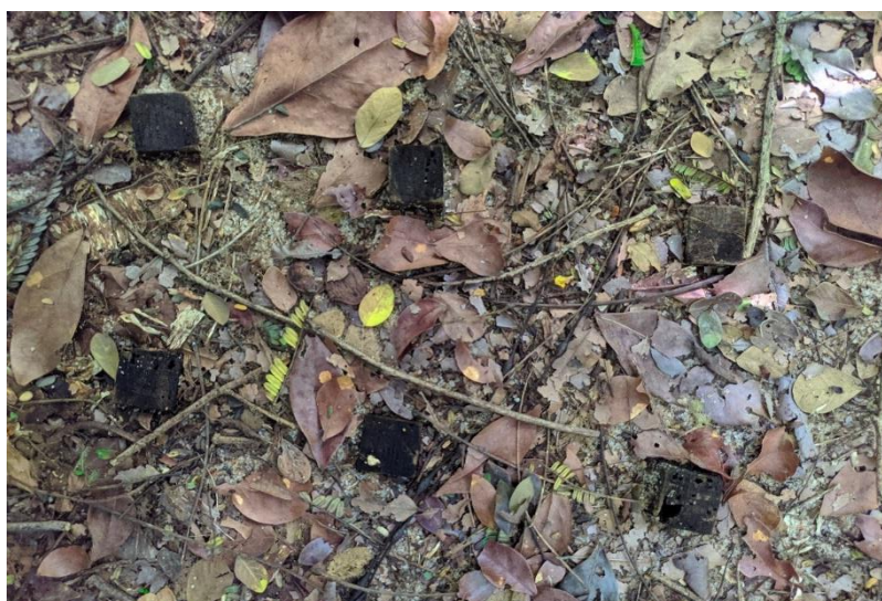
Figura 1. Corpos-de-prova de madeira de Hevea brasiliensis impregnada com nanopartículas de Ag submetidos à deterioração em condições de campo de apodrecimento por 8 meses.
