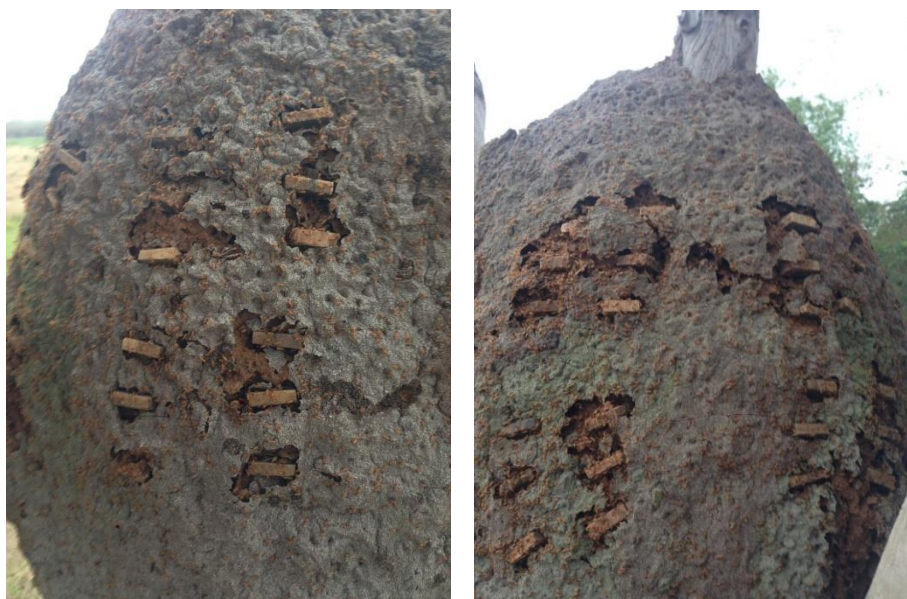
Figura 3. Corpos-de-prova da madeira de Hevea. brasiliensis impregnados com nanopartículas de Ag e expostos a ação de Nasutitermes macrocephalus por 45 dias.
