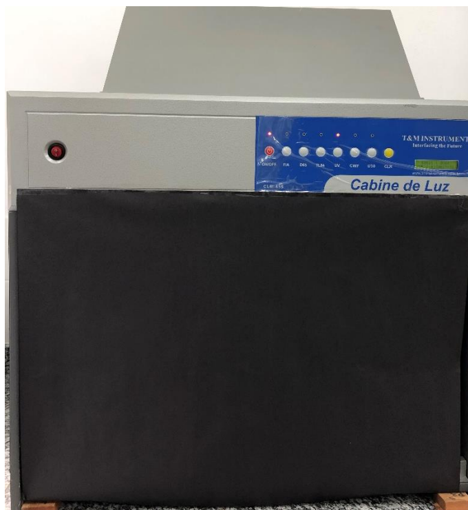
Figura 4: Cabine de luz, da marca T&M Instruments, modelo CL6i-45S, onde foram realizados os ensaios de envelhecimento acelerado (Laboratório de Tecnologia da Madeira, UFRRJ).
