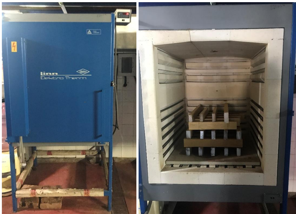
Figura 2: Mufla elétrica laboratorial, da marca Linn Elektro Therm. (Laboratório de Papel e Celulose, UFRRJ).
