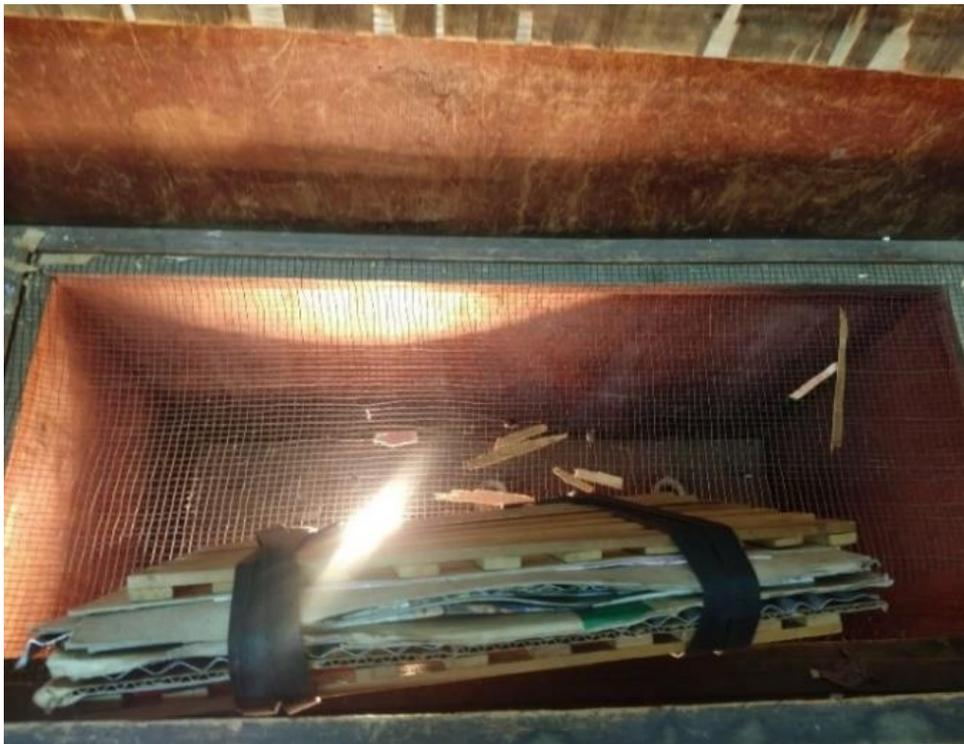
*Figura 12: Secagem em estufa a temperatura média de 60 °C durante três dias.*
