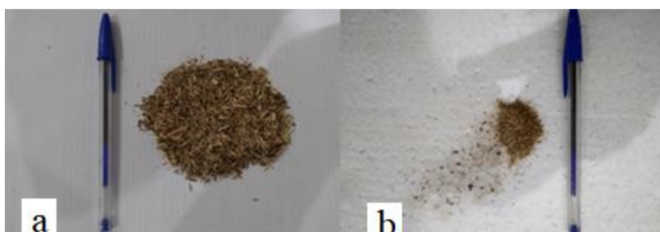
Figura 7: Resíduos lignocelulósicos processados. Sendo: a) Material proveniente do moinho de martelo; e b) Material proveniente do moinho de facas.
