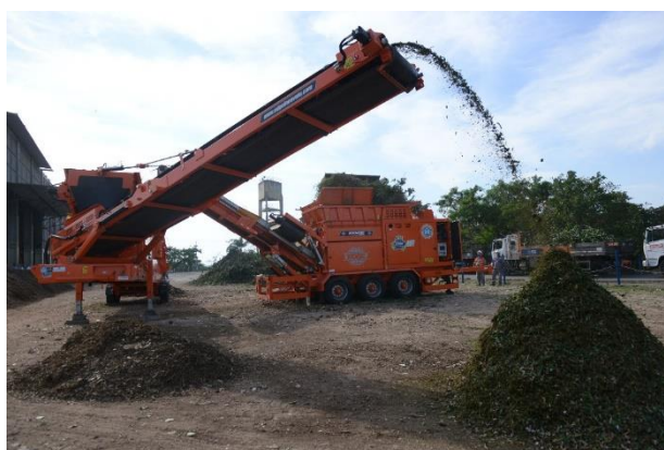
Figura 6: Picador modelo EDGE TRM516, localizado na Estação de Transferência do Caju – COMLURB.
