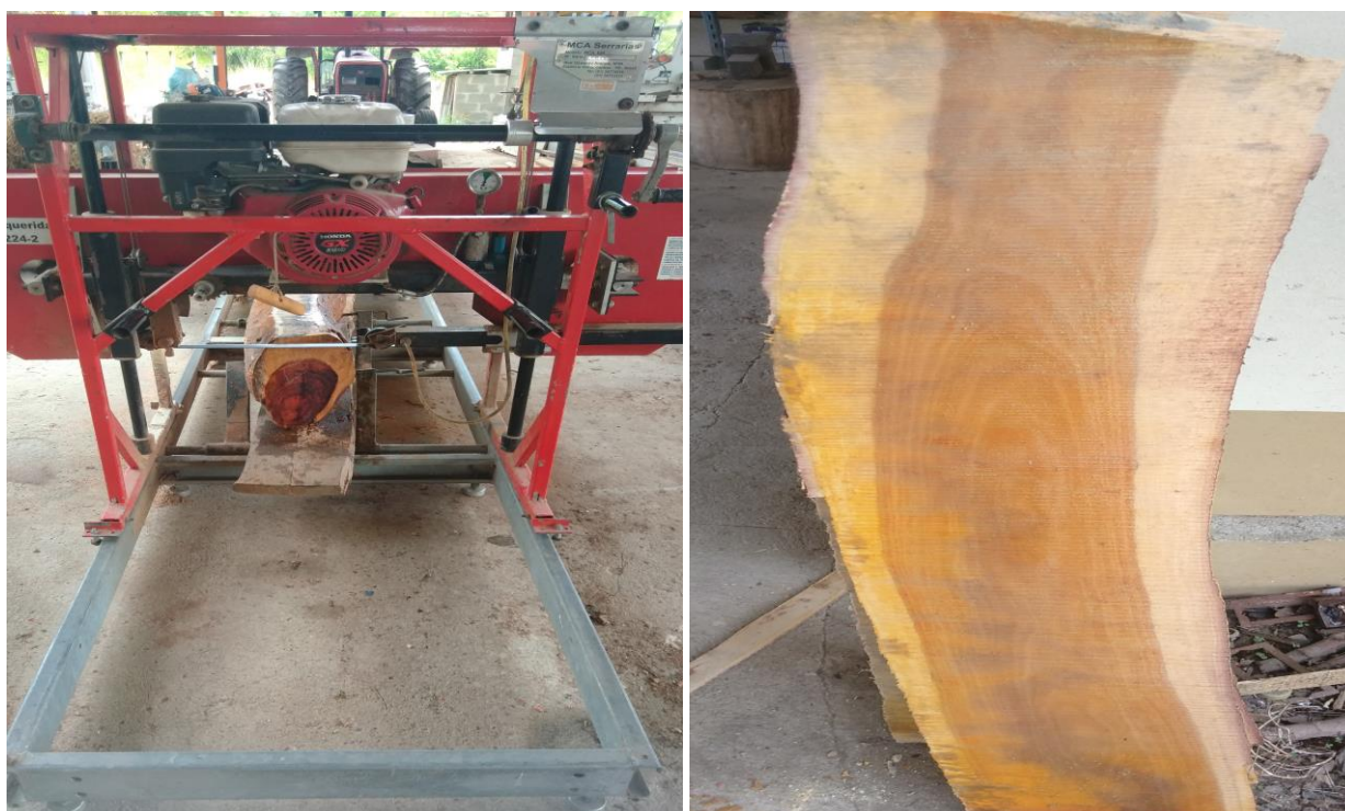
Figura 3. Serra de fita horizontal e prancha de pau-brasil.
