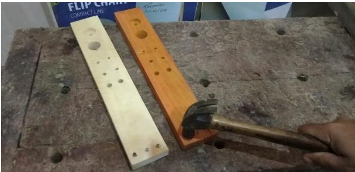
Figura 13. Teste de fendilhamento realizado com martelos e pregos. Fonte: Arquivo pessoal.
