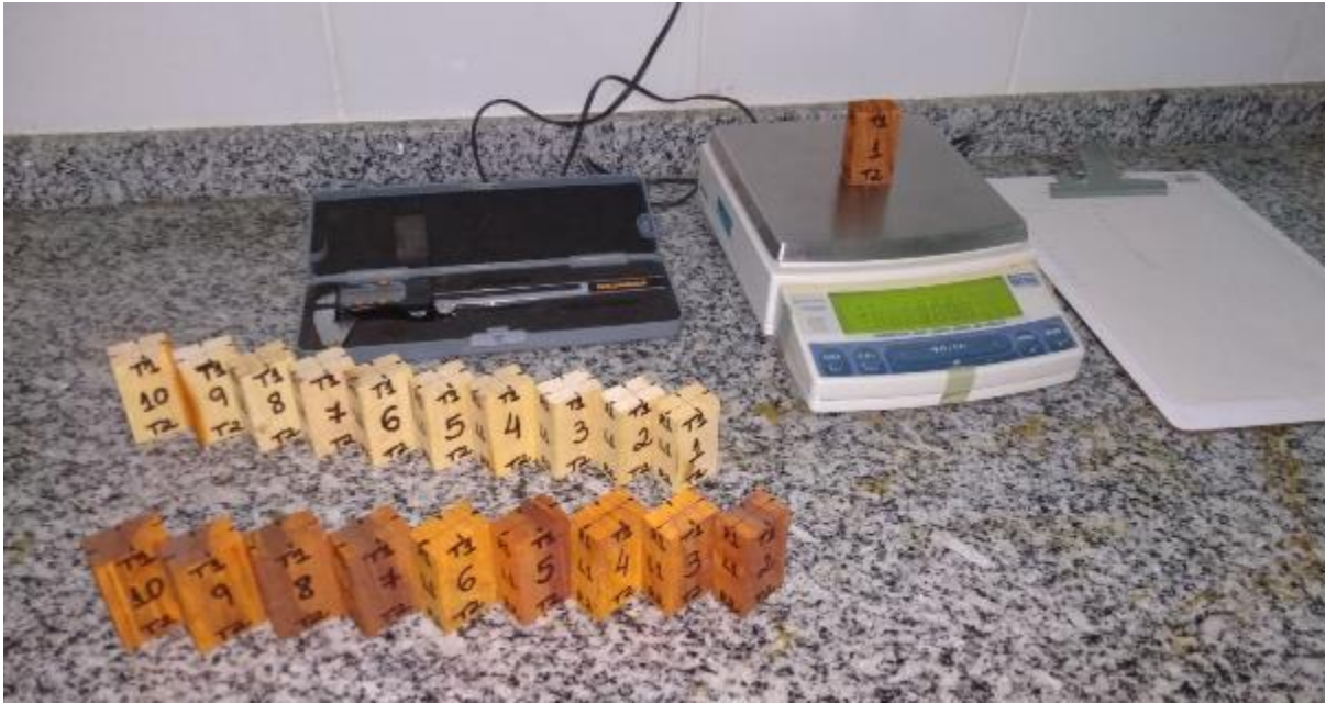
Figura 5. Equipamentos utilizados para medição das dimensões dos corpos de prova. Fonte: Arquivo pessoal.
