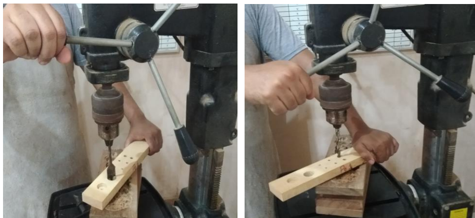
Figura 11. Furadeira vertical utilizada para realizar os furos de cavilha e dobradiça.
