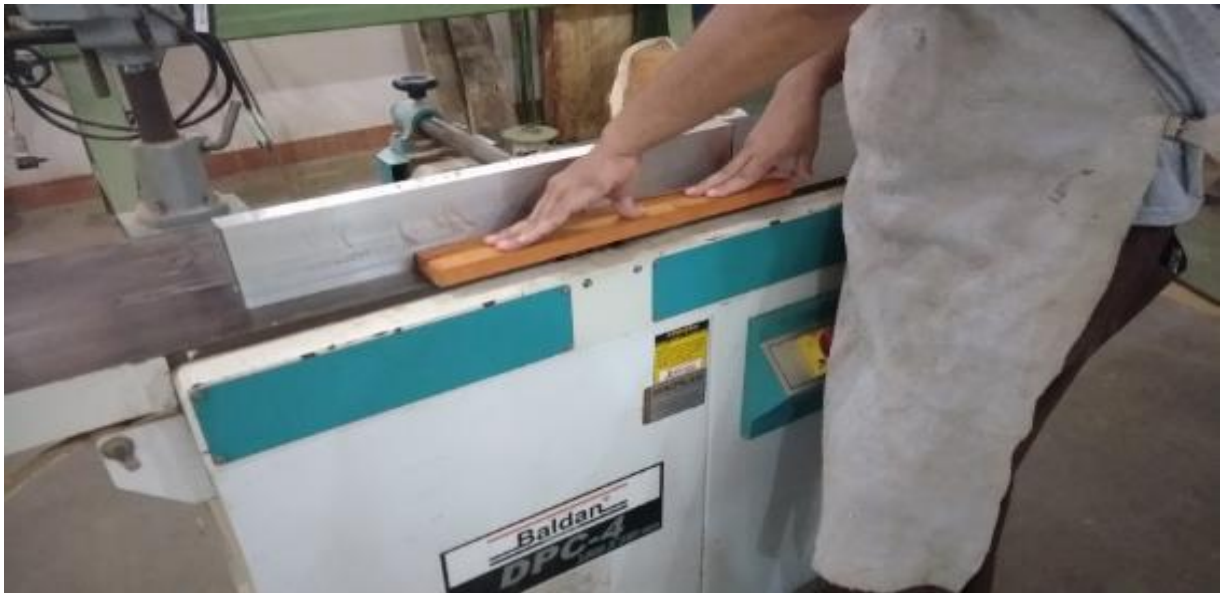
Figura 8. Corpo-de-prova em operação de aplainamento. Fonte: Arquivo pessoal.
