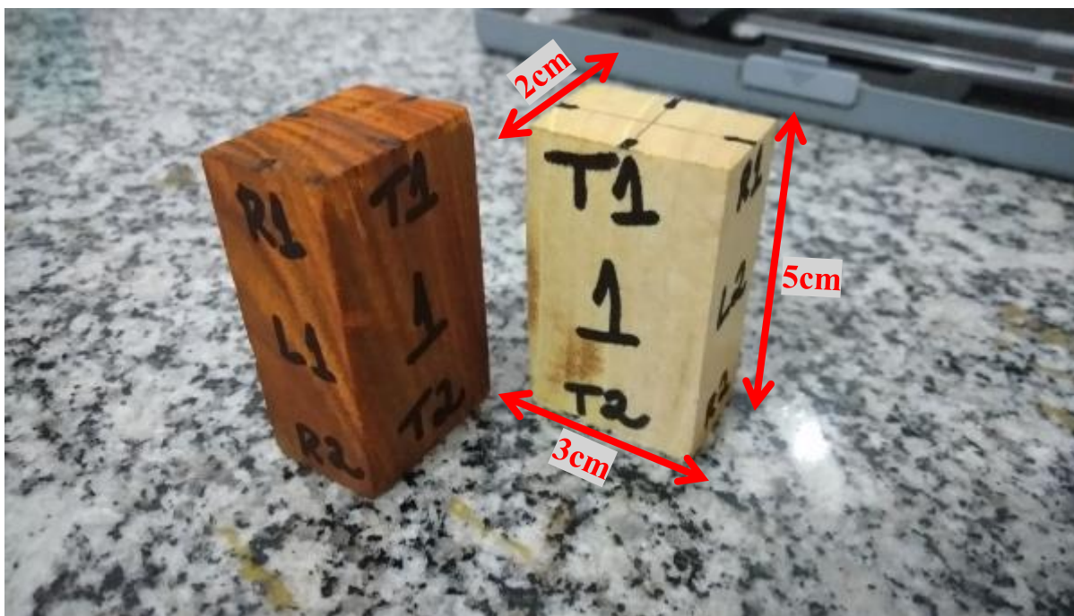
Figura 4. Dimensões dos corpos de prova de propriedades físicas.
