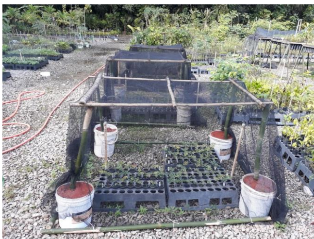
Figura 1: Estrutura preparada para simular diferentes intensidades luminosas por meio do uso de diferentes camadas de tela de poliolefina de cor preta.
