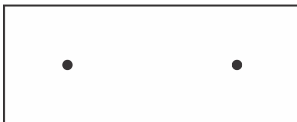
Figura 9. Esquema da amostragem para o ângulo de contato sobre a superfície dos corpos de prova.
