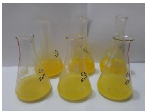
Figura 20. Solução na coloração amarelo fluorescente, indicando a reação dos reagentes com a amostra da madeira em estudo.
