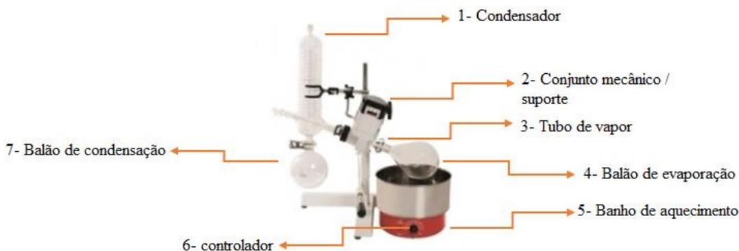
**Figura 22** - Componentes do dispositivo rotativo de evaporação. Fonte: modificado (SPLABOR, 2021).
