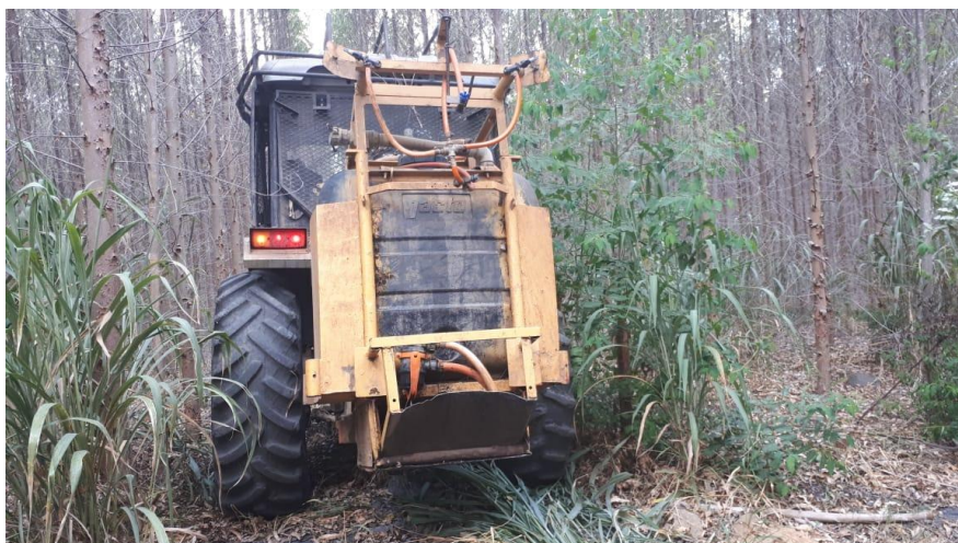
Figura 3: Boomjet, equipamento utilizado para controle de daninhas em florestas altas.
