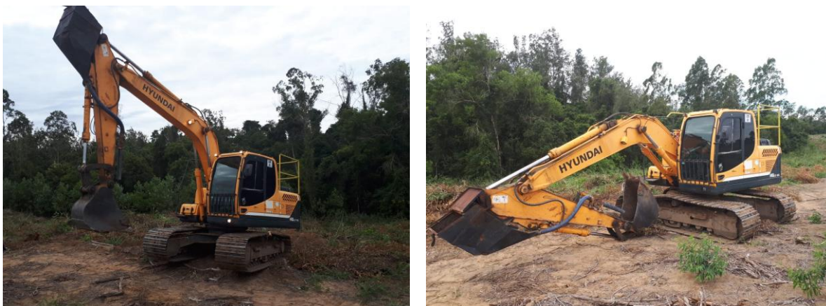
Figura 6: Retroescavadeira com implemento acoplado para coveamento de grota.
