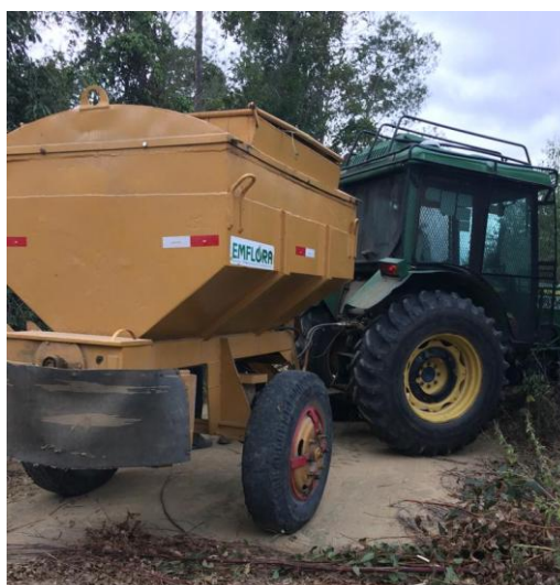
Figura 7: Trator agrícola acoplado ao implemento adubadeira, para adubação.
