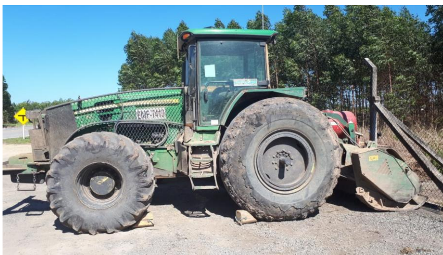
Figura 4: Trator agrícola acoplado ao implemento para rebaixar de toco.
