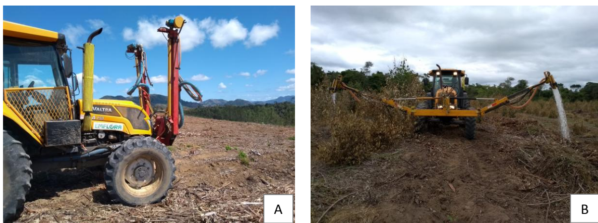
Figura 8: Trator com implemento para irrigação (A) e equipamento em funcionamento (B).
