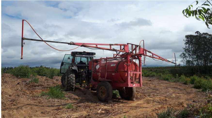
Figura 1: Equipamento utilizado para controle de daninha antes da reforma ou implantação, denominado Barra.
