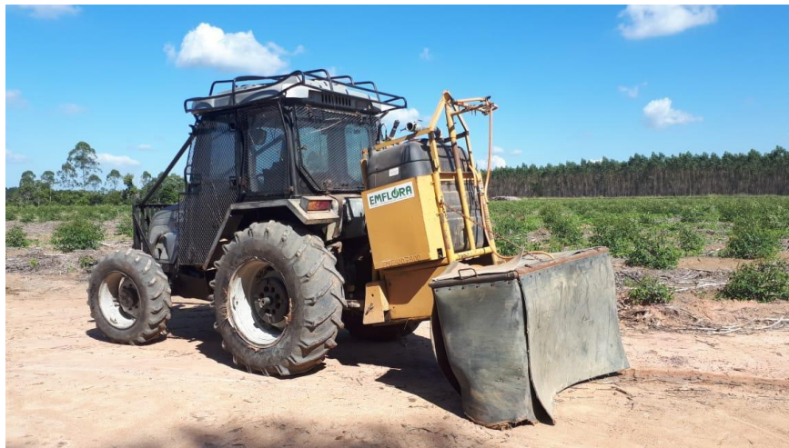
Figura 2: Conceição, equipamento utilizado para controle de erva daninha pós-plantio.
