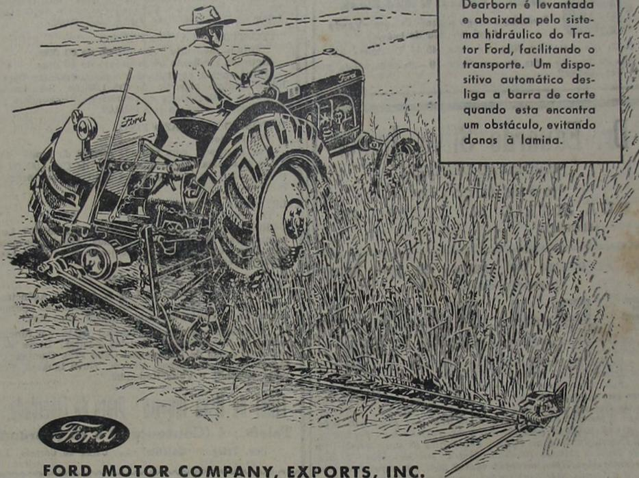
A Ceifadeira Traseira Dearborn é levantada e abaixada pelo sistema hidráulico do Trator Ford, facilitando o transporte. Um dispositivo automático desliga a barra de corte quando esta encontra um obstáculo, evitando danos à lamina.
