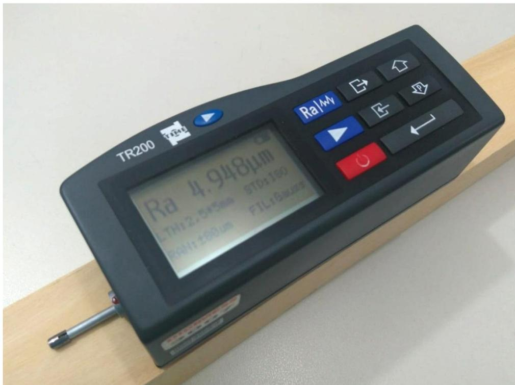
**Figura 9** – Medição da rugosidade com o rugosímetro Digimess, modelo TR 200.
