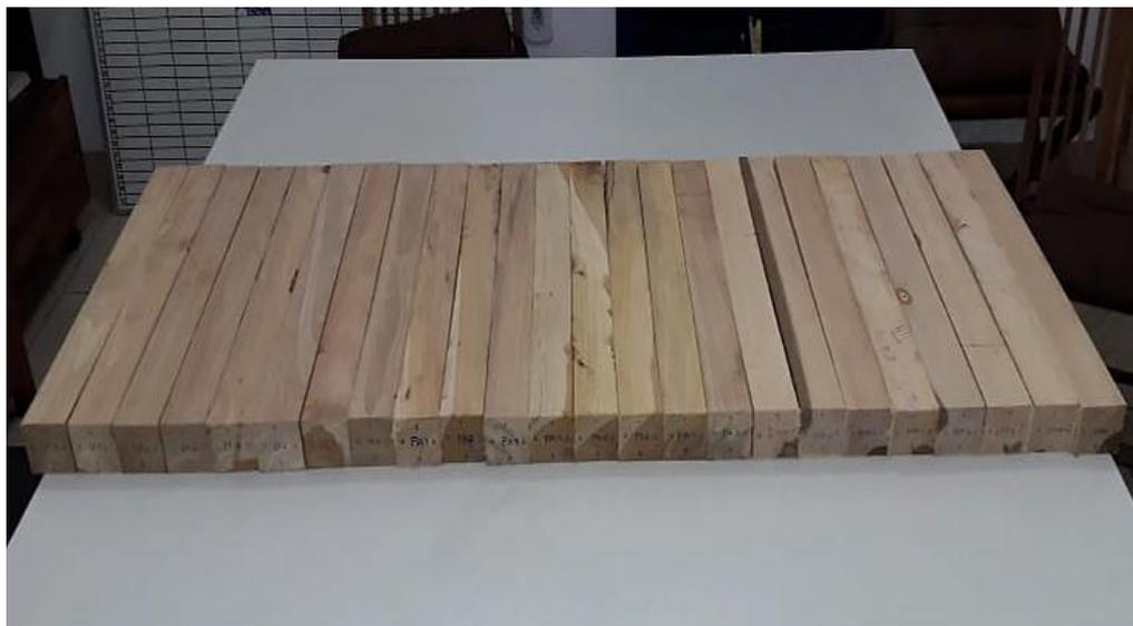
**Figura 6** – Corpos de prova das três espécies estudadas, com dimensões 5 x 5 x 50 cm.
