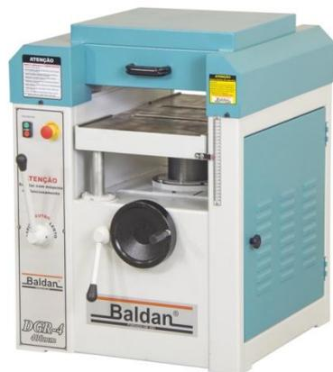
Figura 3 - Plaina Desengrossadeira Mesmo Modelo do Laboratório de Processamento da Madeira. LPM/DPF/UFRRJ
