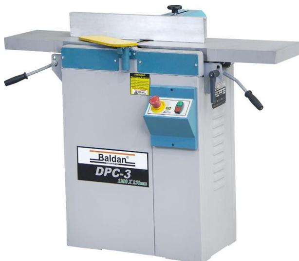
Figura 6 - Plaina Desempenadeira do Mesmo modelo Laboratório de Processamento de Madeira. - LPM/DPF/UFRRJ
