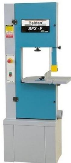
Figura 3- Serra Fita Mesmo Modelo do Laboratório de Processamento - LPM/DPF/UFRRJ
