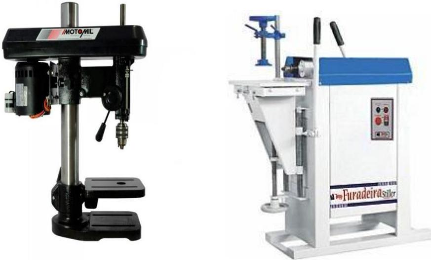
Figura 10 : Furadeira Vertical e Horizontal Mesmo Modelo do Laboratório de Processamento da Madeira. LPM/DPF/UFRRJ
