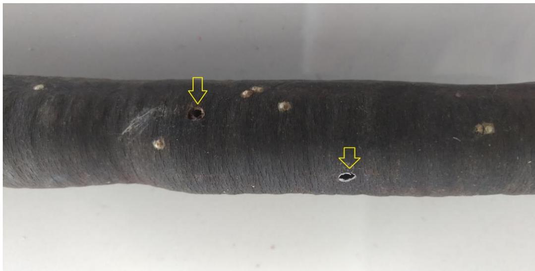
**Figura 8.** Orifícios causados pela emergência de insetos.
