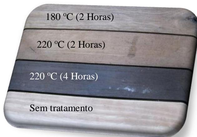
Figura 10. Madeira de *E. urophylla* termorretificada em três condições distintas e sem tratamento térmico.
