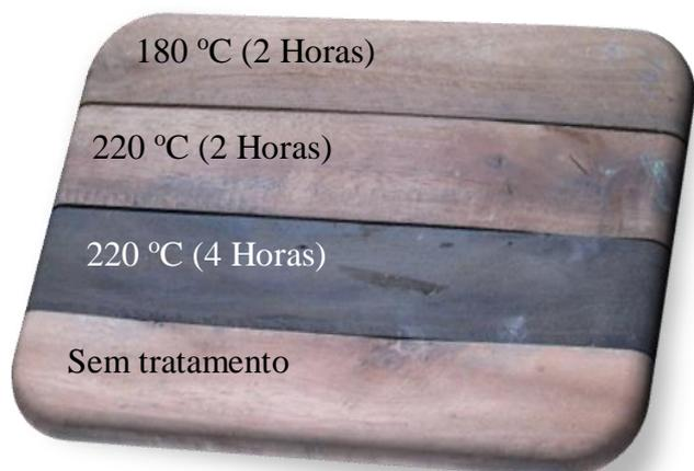
Figura 9. Madeira de *E. pellita* termorretificada em três condições distintas e sem tratamento térmico.
