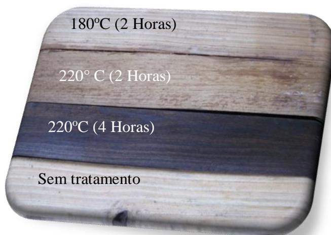
Figura 8 Madeira de *P. caribaea* termorretificada em três condições distintas e sem tratamento térmico.
