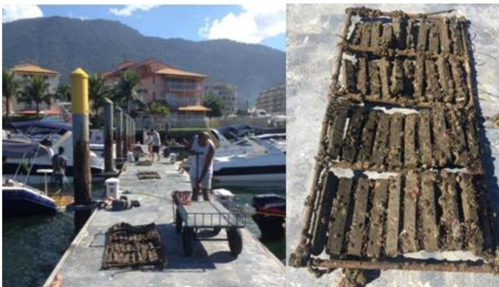
Figura 14. Procedimento de retirada das amostras após cinco meses de exposição em ambiente marinho.
