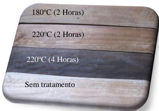
Figura 7. Madeira de *C. citriodora* termorretificada em três condições distintas e sem tratamento térmico.
