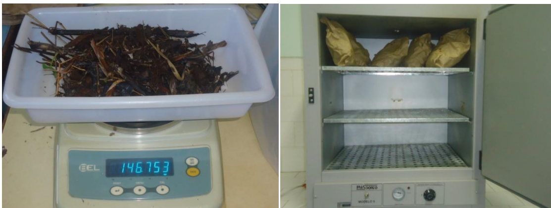
Figura 10: Pesagem da serrapilheira e acondicionamento em estufa.
