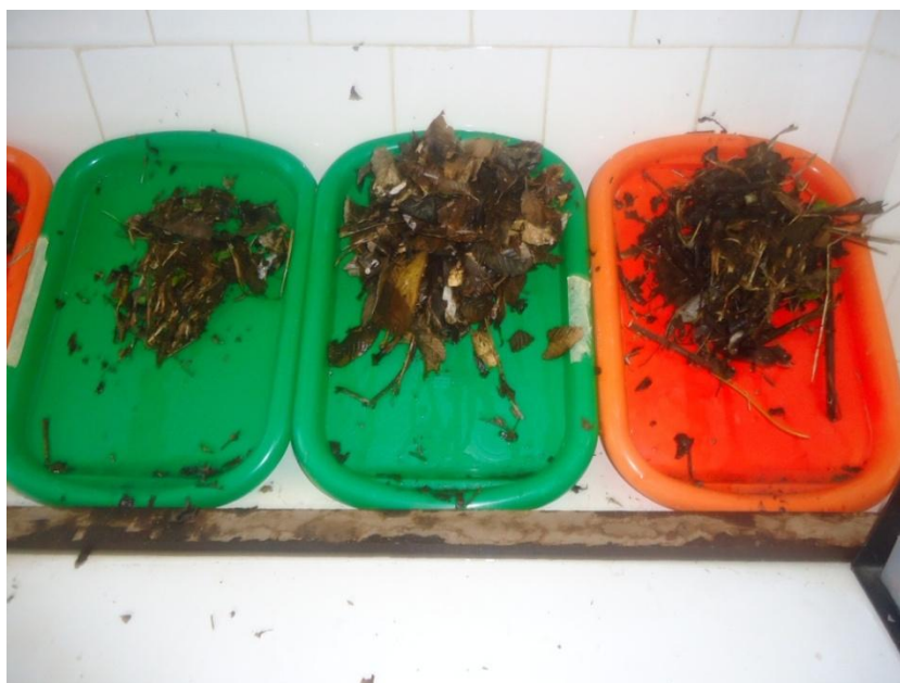
Figura 9: Dreno do excedente por 30 minutos em bandejas dispostas com 30% de declividade
