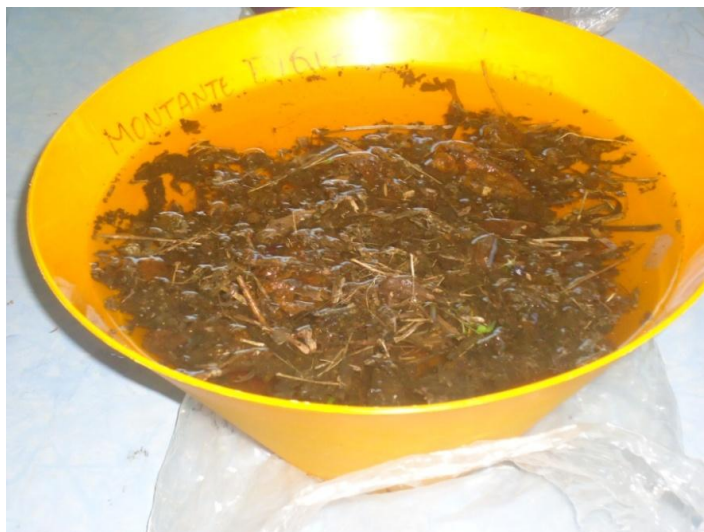
Figura 8: Imersão da serrapilheira em água por 90 minutos para encharcamento da amostra
