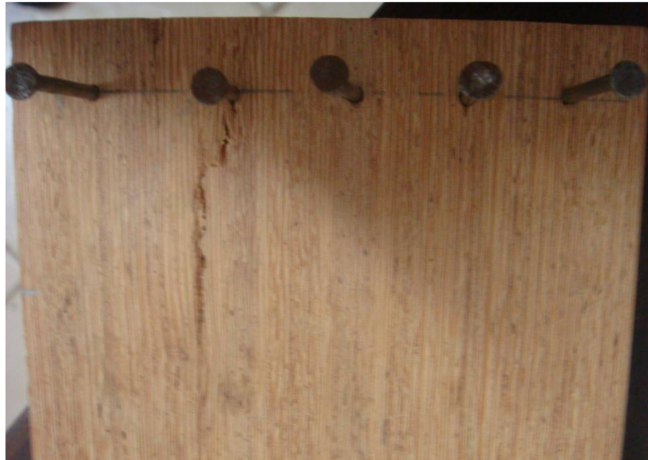
Figura 9. Ilustração do teste de fendilhamento por pregos (trincas e rachaduras).
