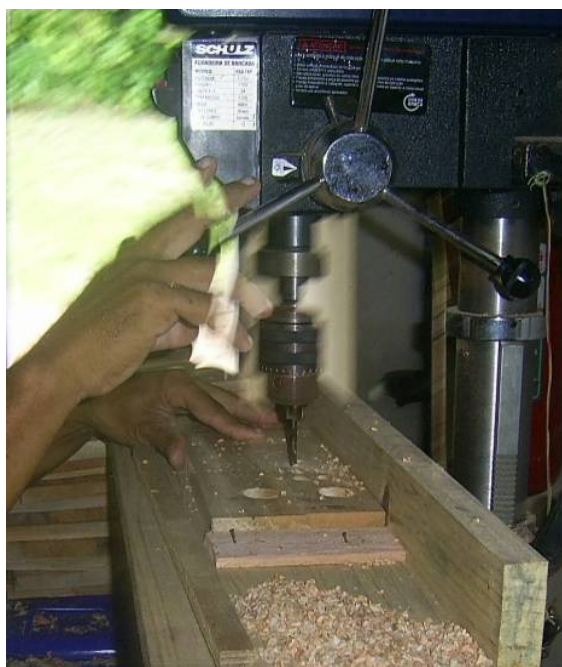
Figura 7. Detalhe da realização do teste de furação.
