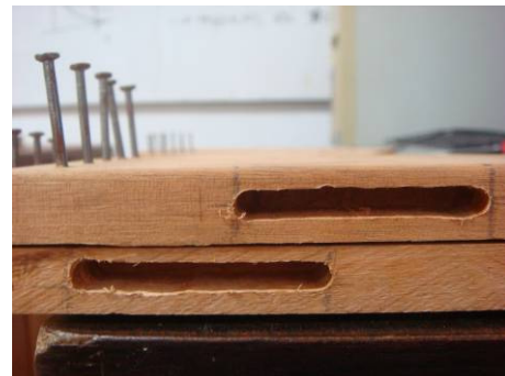
Figura 8. Ilustração do rasgo produzido na lateral das amostras
