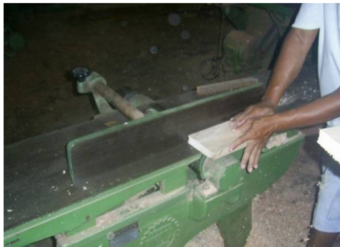
Figura 6. Exemplo de realização do aplainamento das amostras.
