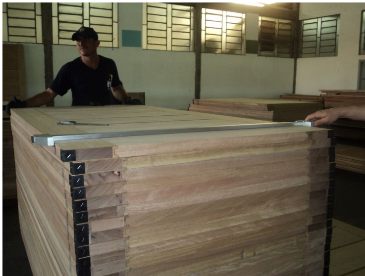
Figura 7: Medição da largura da porta com o paquímetro digital.
