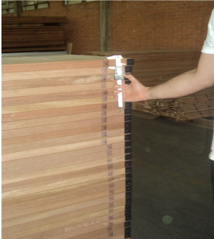
Figura 6: Medição da espessura da porta com o paquímetro digital.
