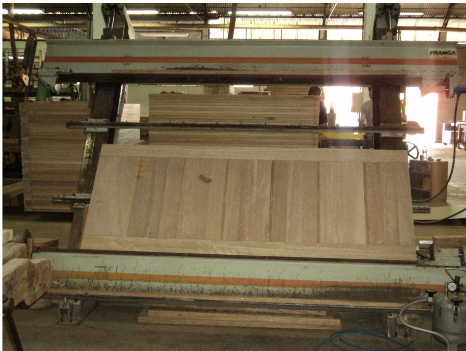
Figura 13: Máquina de prensagem da porta montada na Indústria Madeireira Uliana.
