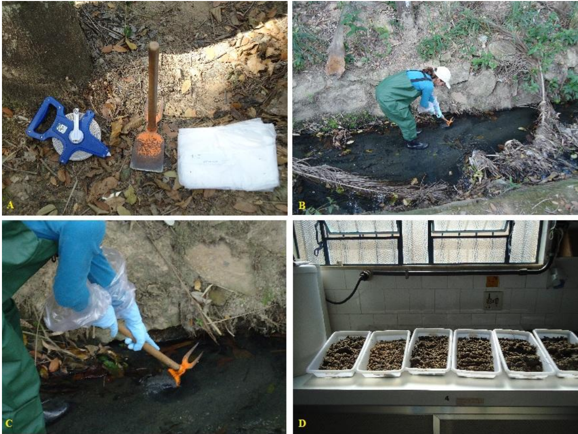
Figura 21: Coleta de amostra de sedimentos para análise granulométrica. (A) Material utilizado na coleta; (B e C) Coleta de amostra no vértice esquerdo; (D) Amostras coletadas dispostas em recipientes plásticos para secar ao ar livre.
