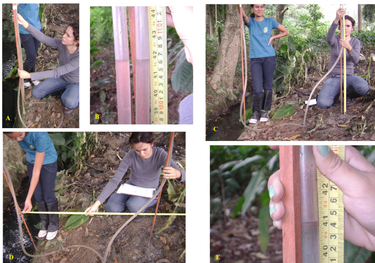
Figura 18: Método do nivelamento com mangueira para a determinação do perfil do terreno no entorno da calha; (A) Coleta da altura do nível d'água em relação ao vértice da calha após estabilização do mesmo; (B) Estabilização do nível d'água; (C) Coleta da altura do nível d'água no ponto “n”; (D) Medição da distancia entre o vértice da calha e o ponto “n”; (E) Detalhe da medida da altura do nível d'água.
