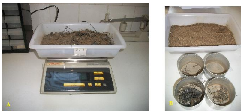
Figura 22: Pesagem da amostra coletada em balança analítica (A) e divisão da mesma em grupos (B).
