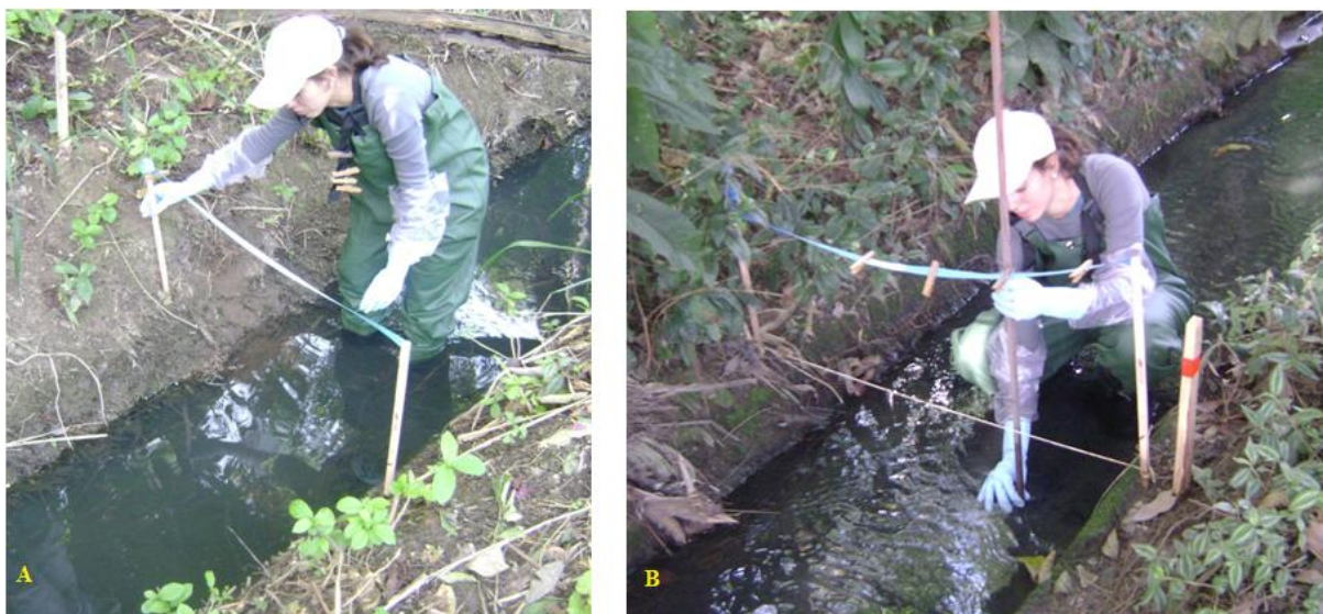
Figura 14: Medições realizadas à montante do ressalto hidráulico com o auxílio de instrumento de apoio e estaca de madeira (150 x 1 x 1 cm), ilustrando o dimensionamento da calha (A) e a coleta do nível d'água o ponto “n” (B).
