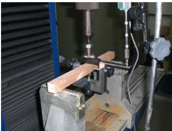
Figura 5. Detalhe do ensaio de flexão estática.
