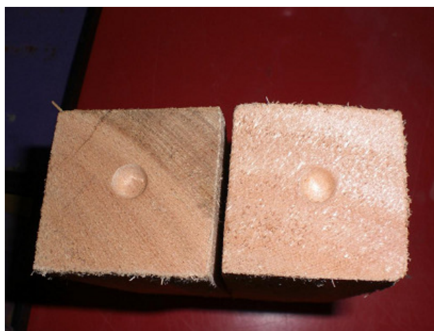
Figura 5. Corpos-de-prova após ensaio de Dureza Janka.
