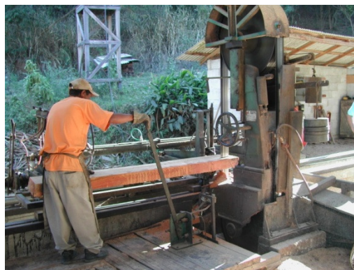
Figura 1. Desdobro das toras na serra de fita vertical.
