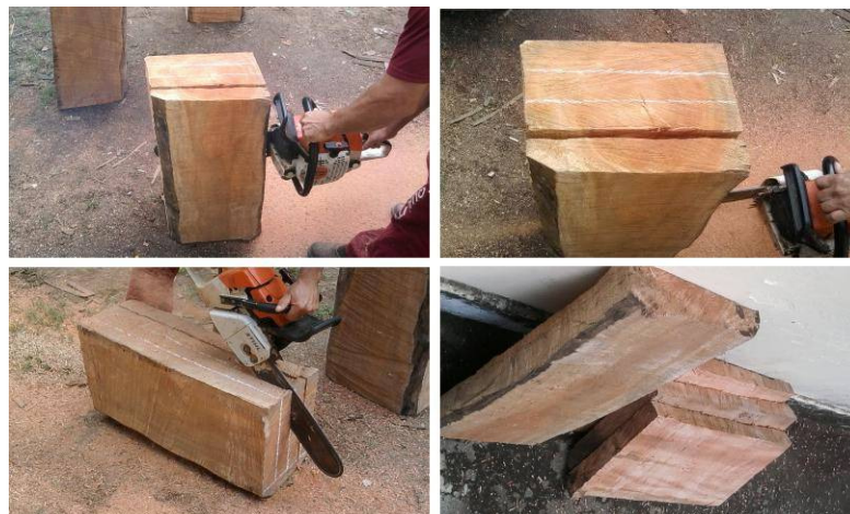
Figura 8. Sequência de imagens do desdobro primário das toras, com auxílio de moto-serra e operador.
