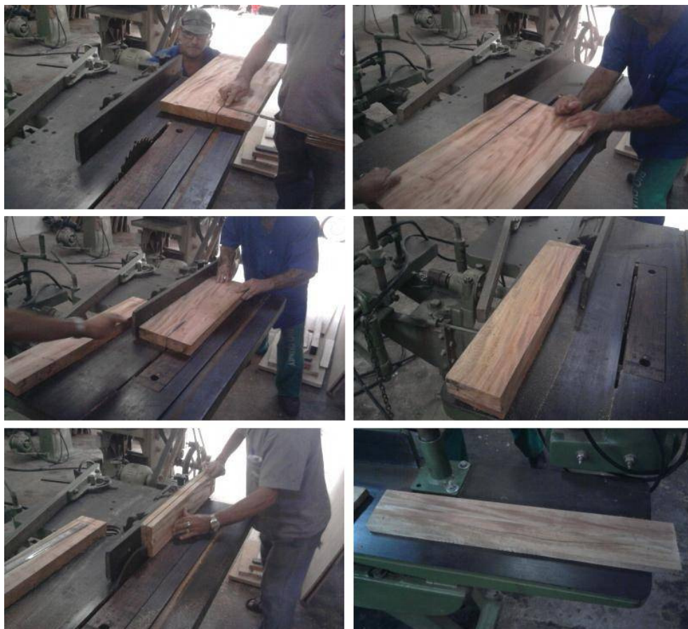
Figura 9. Seqüência de imagens sobre a confecção dos corpos-de-prova.
