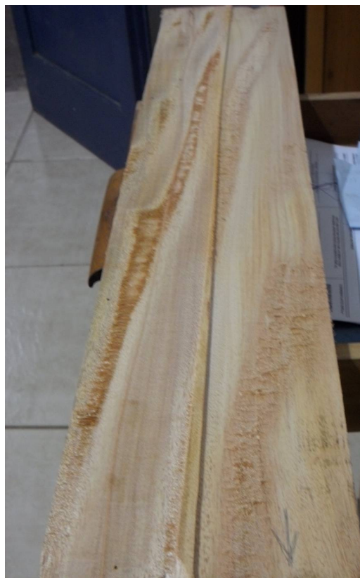
Figura 24. Corpo-de-prova aplainado sob velocidade de avanço de 24 m/min, detalhe dos defeitos gerados em toda superfície, tanto no sentido a favor, quanto contra a orientação das fibras.
