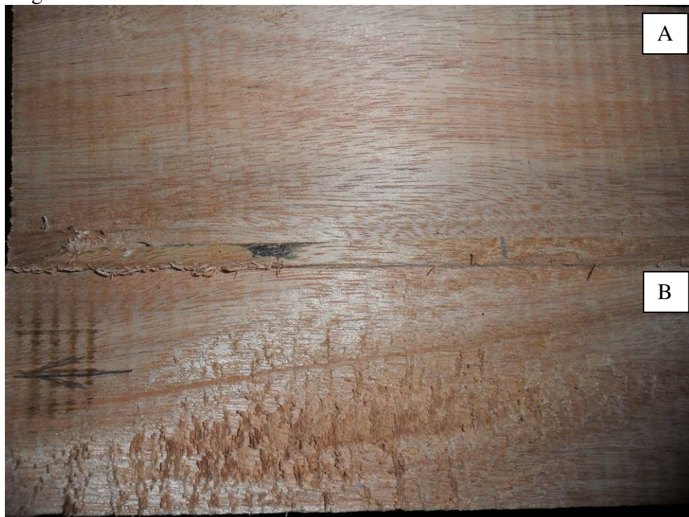
Figura 23. Velocidade de avanço 12,4 m/min: (A) aplainamento a favor da orientação da grã; (B) aplainamento contra orientação da grã.
