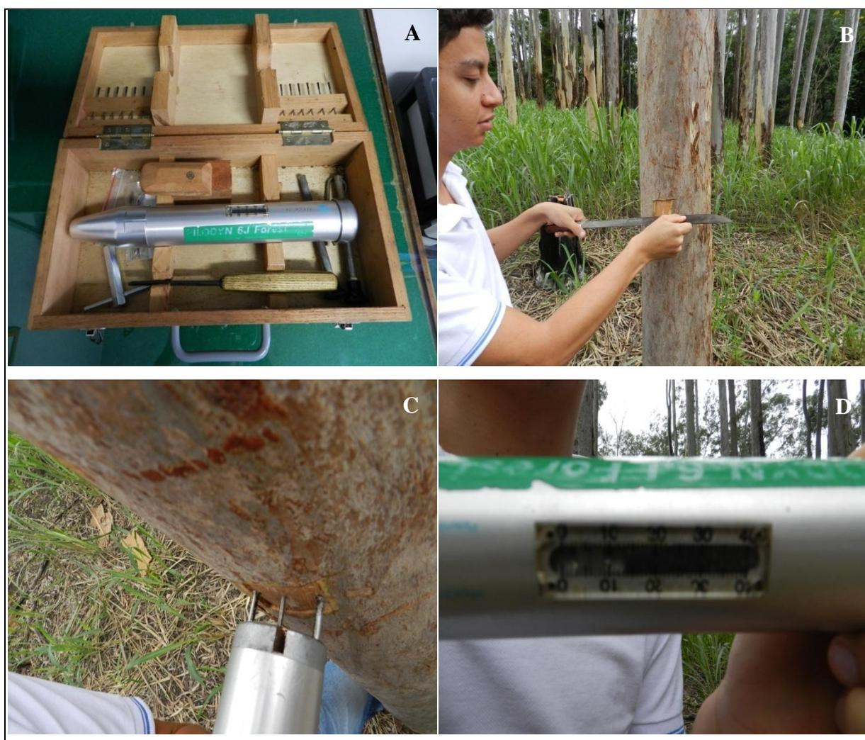
**Figura 1:** A. Aparelho Pilodyn Forest 6J. B. Descascamento em secções retangulares no tronco das árvores. C. Funcionamento do Pilodyn através da penetração do pino na madeira. D. Leitura em milímetros dos valores através do visor do Pilodyn.
