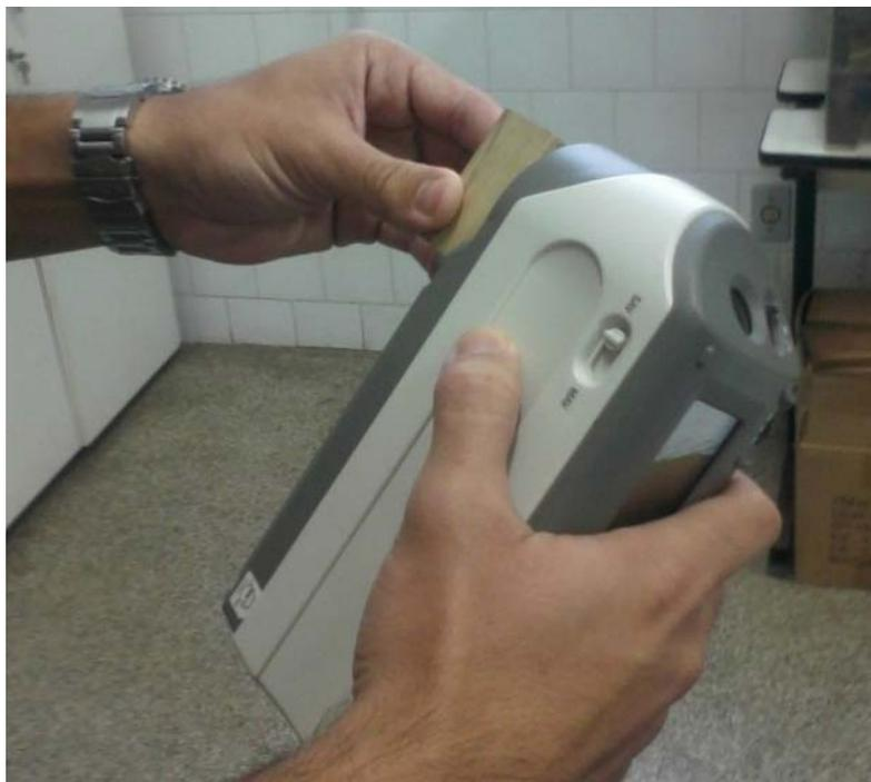
Figura 4. Espectrofotômetro portátil CM 2600d (Konica Minolta) utilizado para as análises colorimétricas.
