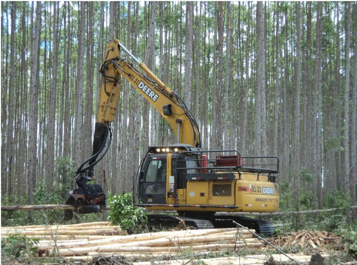
Figura 1 *Harvester* John Deere 200C LC cabeçote JD Waratah 270. Fonte: arquivo pessoal.
