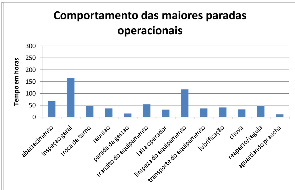
Figura 41 Paradas operacionais com maiores perdas de tempo do *harvester* John Deere 200C LC cabeçote JD Waratah 270, máquina 280129.
