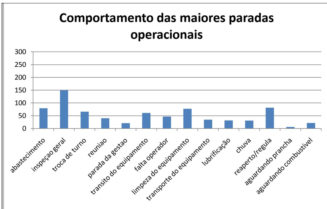
Figura 47 Paradas operacionais com maiores perdas de tempo do *harvester* John Deere 200D LC cabeçote JD Waratah 270, máquina 280134.
