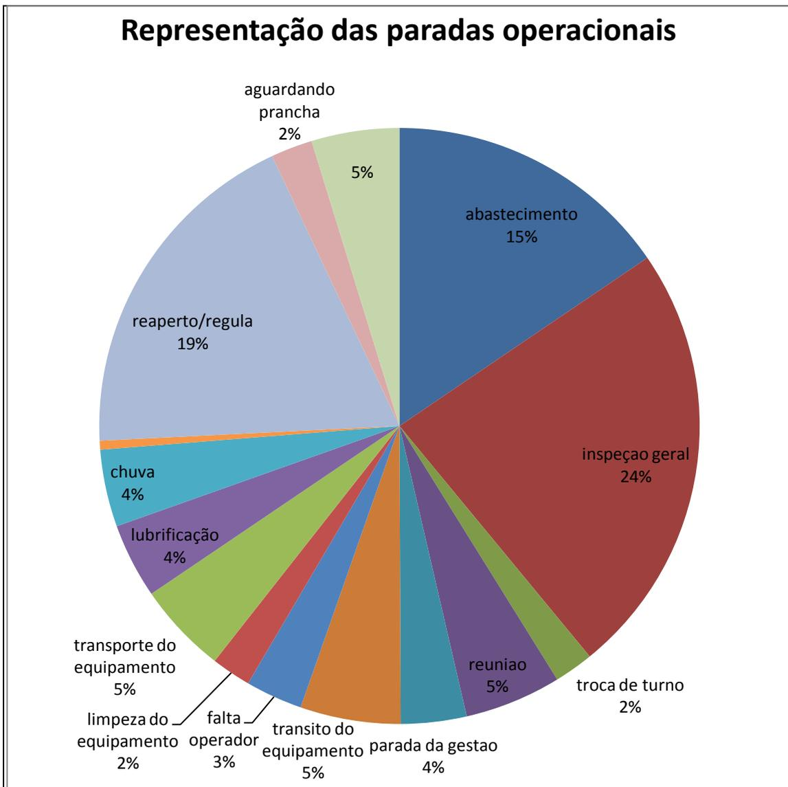
Figura 30 Representação das paradas operacionais do *harvester* John Deere 200C LC cabeçote JD Waratah 270, máquina 280121.
