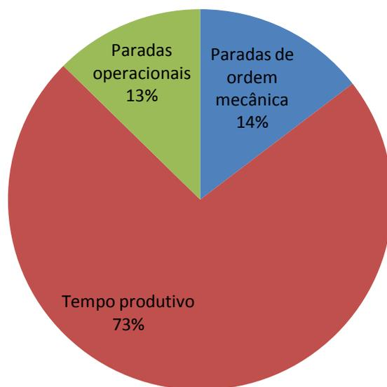
Figura 49 Representação dos tempos totais para o *harvester* John Deere 200D LC cabeçote JD Waratah 270, máquina 280134.
