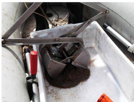
Figura 5. Utilização da Van Veen para coleta do sedimento.
