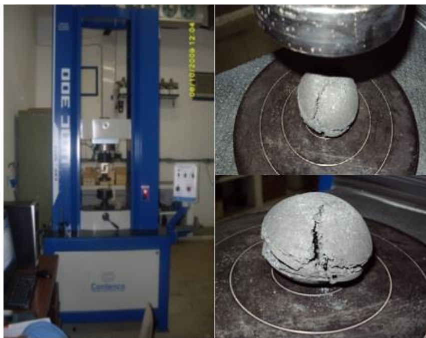
Figura 4. Máquina universal e aplicação de carga ao briquete durante o ensaio de compressão.
