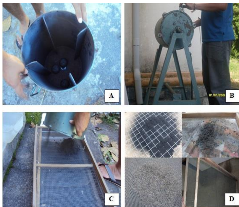
Figura 5. Interior do tambor rotativo (A), tambor sendo rotacionado (B) e peneiramento dos briquetes depois de submetidos à ação do tamboramento (C e D).
