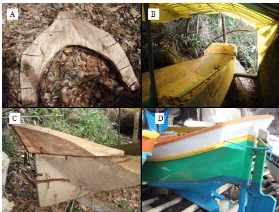
Figura 8. Principais partes estruturais das embarcações: A. “Cabeça”; B. “Cabeça” acoplada à popa; C. “Cabeça” acoplada à proa; D. Canoa com motor de centro mostrando o acabamento da popa e do leme.
