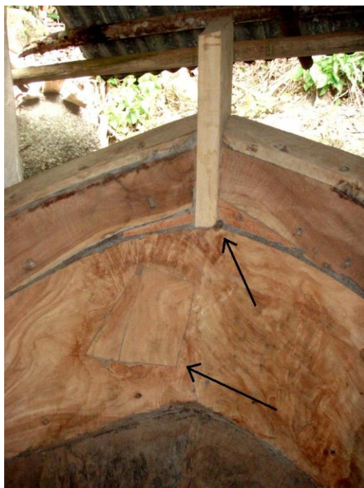
Figura 9. Reparo feito na proa de embarcação em fase de acabamento.
