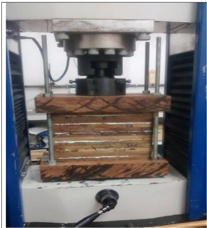
Figura 5 - Adaptação feita à máquina universal de ensaios mecânicos, com capacidade de 30 toneladas, onde são prensadas as juntas.
