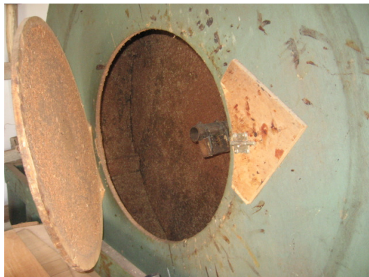
Figura 18. Tambor rotatório da encoladeira utilizada na aplicação do adesivo.
