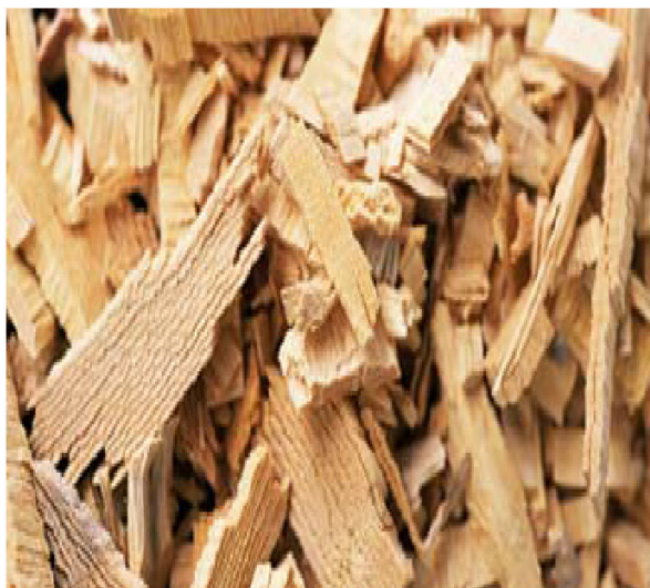
Figura 3. Partículas utilizadas na produção do OSB (cortadas no sentido longitudinal às fibras). Fonte: CICHINELLI, 2005 - www.portalosb.com.br
