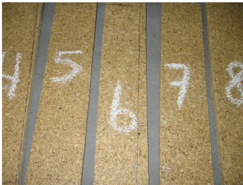
Figura 21. Detalhe de corpos-de-prova confeccionados a partir das chapas com três camadas (maior granulometria no miolo e menor nas capas).
