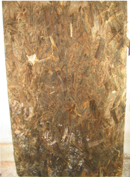
Figura 11. Painel de OSB usado amostrado (com aproximadamente 1 ano de uso em ambiente externo da obra).
