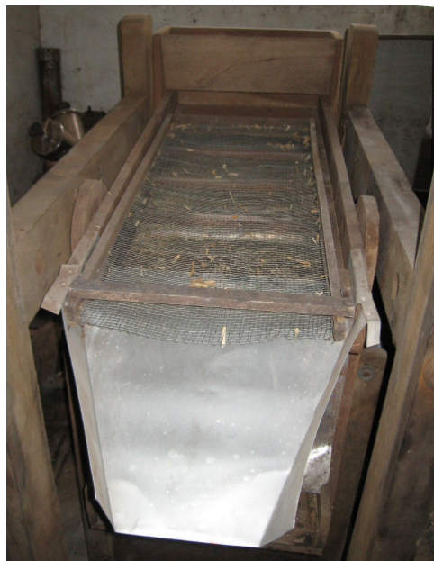
Figura 16. Peneira classificatória utilizada para separação granulométrica.
