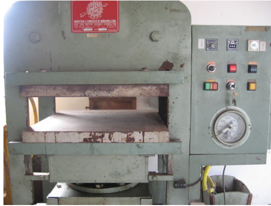
Figura 19. Prensa hidráulica com aquecimento por resistências elétricas utilizada na prensagem das partículas.
