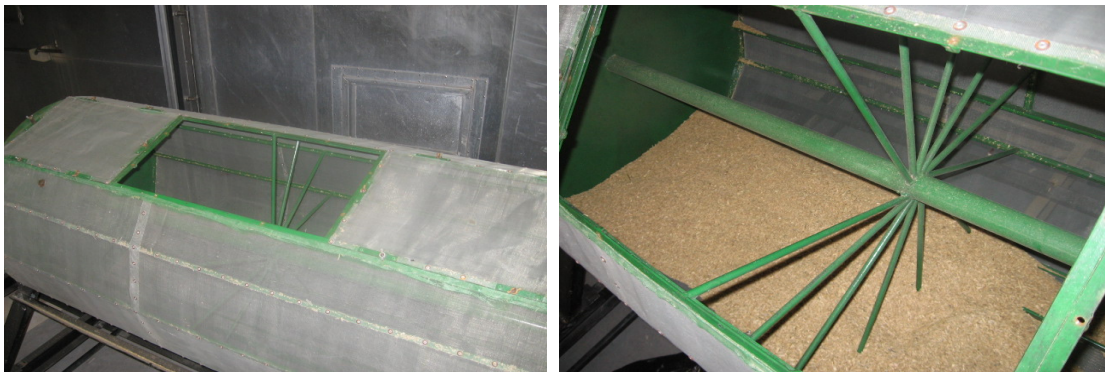
Figura 17. Tambor giratório com tela metálica utilizado na secagem das partículas.
