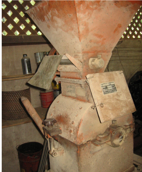
Figura 15. Moinho de martelo utilizado na geração de partículas menores.
