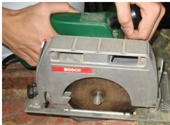
Figura 14. Corte dos painéis usados em pedaços utilizando serra circular manual.
