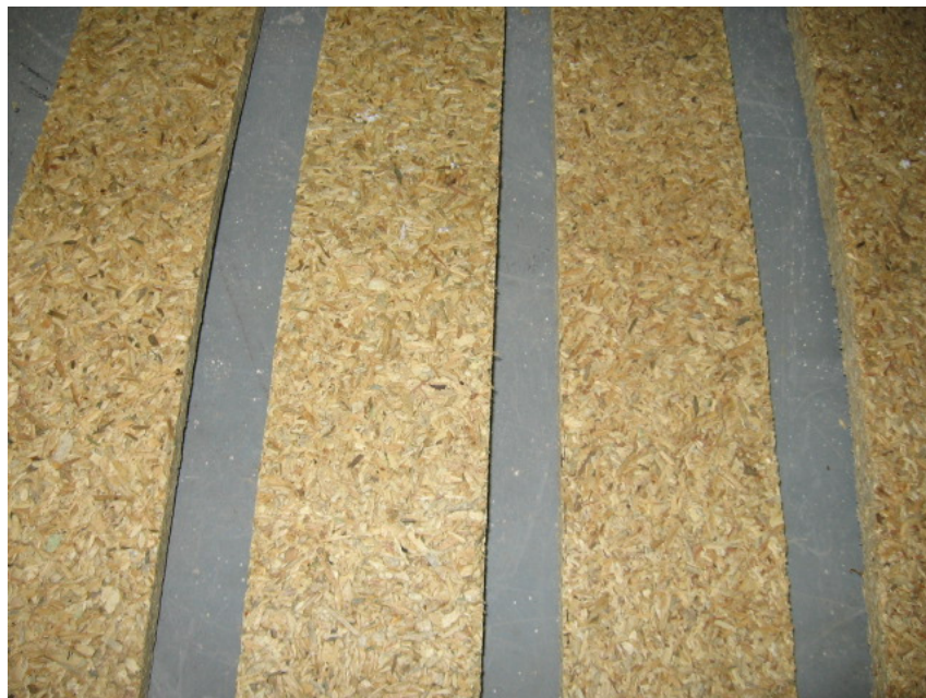
Figura 20. Detalhe de corpos-de-prova confeccionados a partir das chapas com 100% de partículas de maior granulometria.
