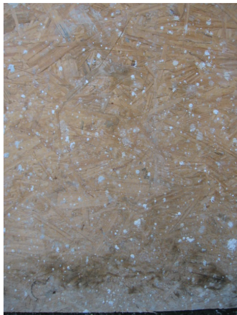
Figura 12. Painel de OSB usado amostrado (com aproximadamente 1 ano de uso em ambiente interno da obra).
