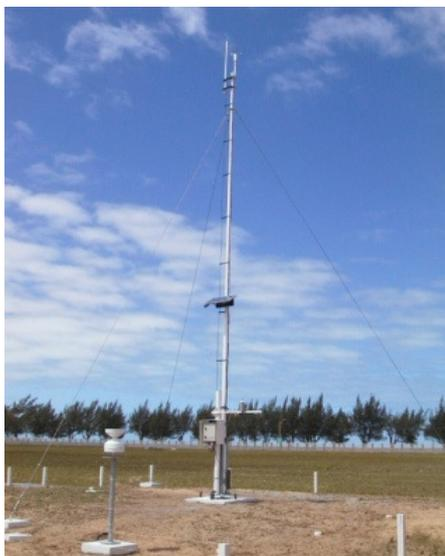
Figura 4. Estação Meteorológica automática.
