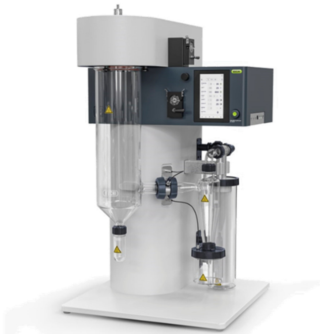
Figura 4. Equipamento spray dryer utilizado na pesquisa. Fonte: Acervo fotográfico do Autor.
