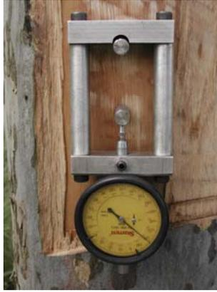
Figura 4. Extensômetro instalado em árvore de *E. citriodora*
