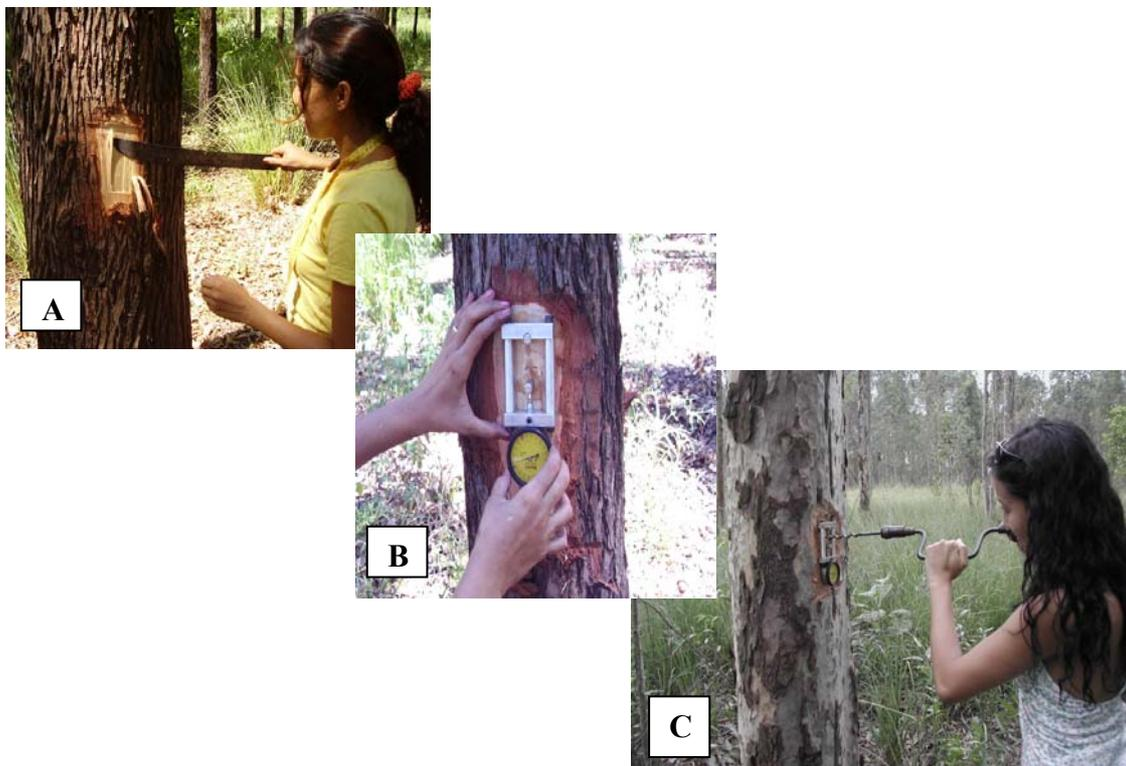
Figura 5. A: Abertura de painel para fixação do extensômetro. B: Fixação do extensômetro. C: Perfuração do tronco com arco de pua para liberação das tensões.
