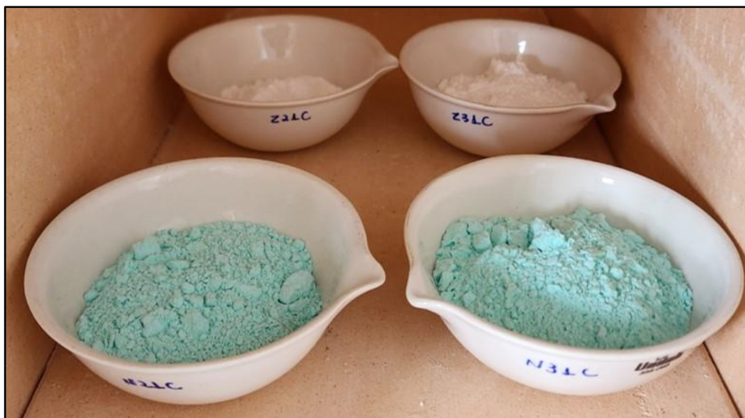
Figura 10 – HDLs Ni-Al e Zn-Al na mufla antes da calcinação
