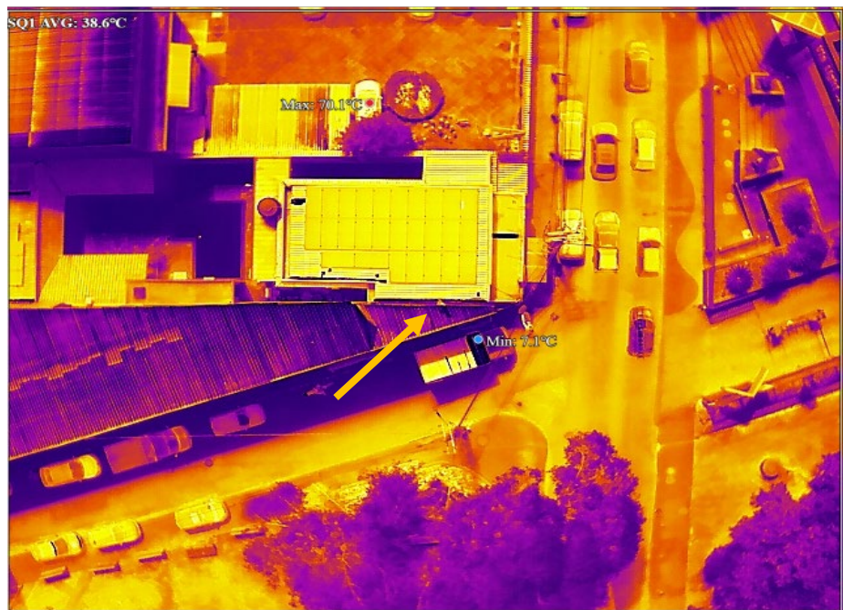
Fotografias 12 e 13: Voo 1 – 60m: Imageamento térmico sobre as estações Mestre Hiram e IM UFRRJ (GSD = 1,06cm/px) 04/09/2024 - 11:16:50 04/09/2024 - 12:00:15
