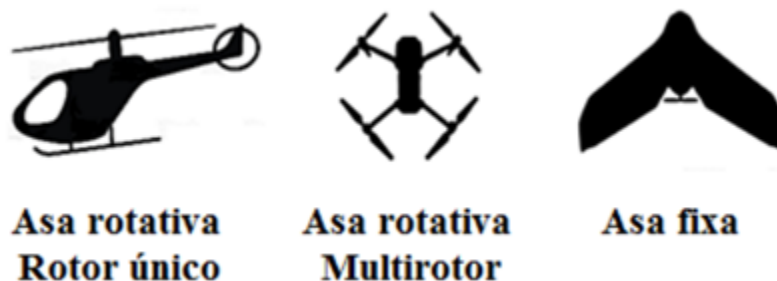
Figura 18: Classificação dos RPAS quanto ao modelo de asa.
