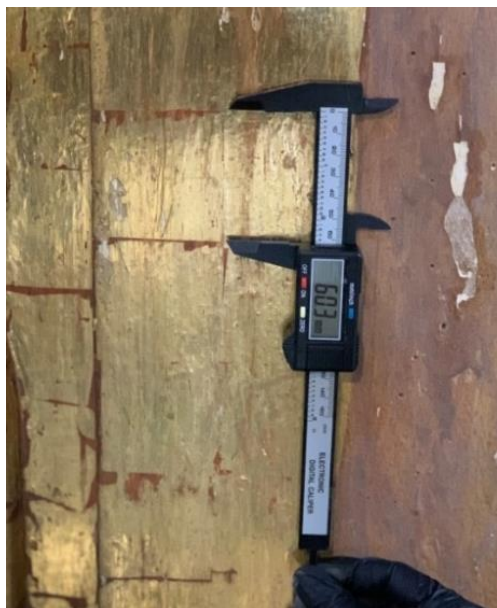
Figura 11. Pormenor do Retábulo-mor de Nossa Senhora do Pilar, medição das folhas metálicas, altura. Fonte: Elaine Gusmão, com uso de paquímetro digital, 2021.
