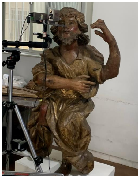
Figura 76. Equipamento portátil de EDXRF (tubo de raios X, detector). Exame na escultura do Rei Davi. Duque de Caxias/RJ. Fonte: Elaine Gusmão, 2021.
