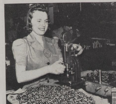
Outra operária inspeciona esferas de bielas de motores de aviões. Muito depende da sensibilidade de seus dedos.
