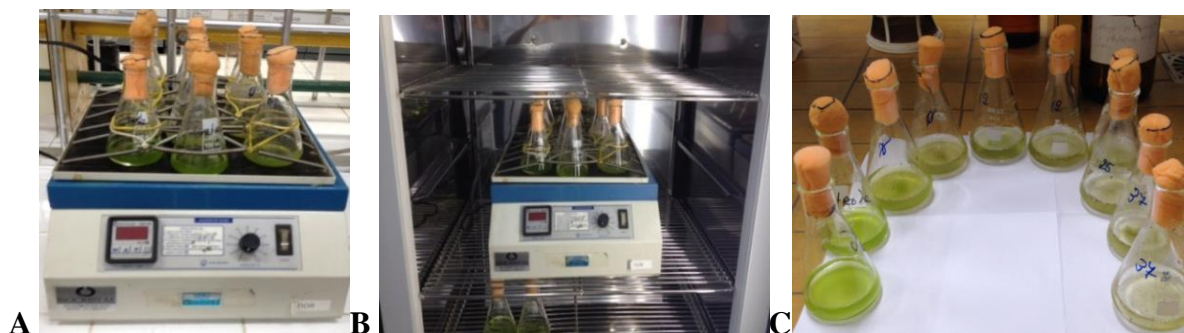
Figura 4. Montagem do ensaio de inibição de crescimento algal.
