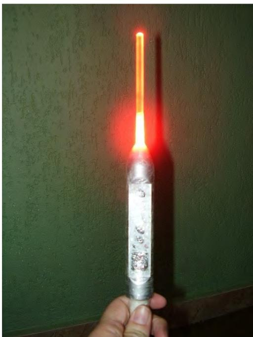
Figura 4: Aparelho de laser STARLASER® da Microdont® com ponteira de acrílico adaptada.
