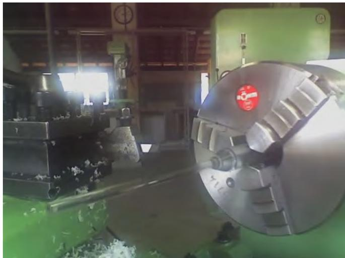
Figura 6: Fabricação da ponteira de acrílico na oficina Óptica da UNIVAP.
