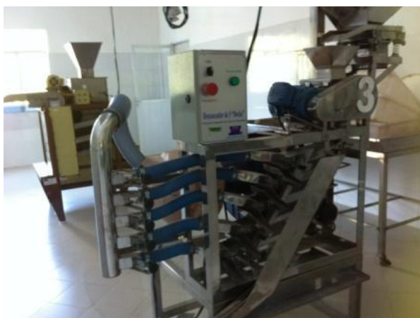
Figura 38: Máquina de descascamento das amêndoas – Ceplac, Ilhéus/BA
