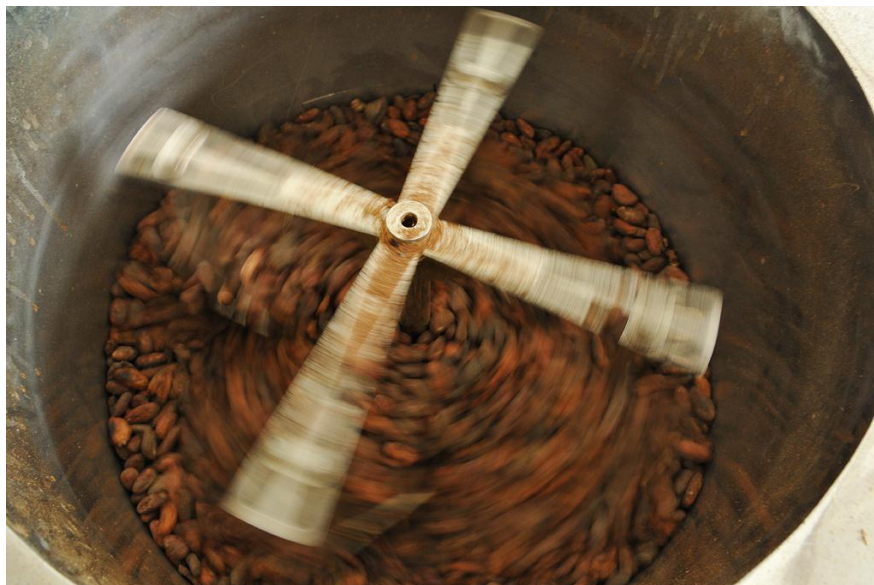
Figura 37: Processo de torrefação das amêndoas do cacau
