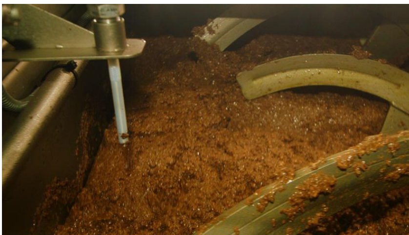
Figura 41: Processo de conchagem do cacau
