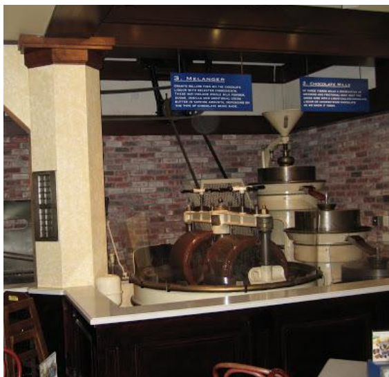
Figura 26: Mélanger – maquinário para processamento da amêndoa do cacau
