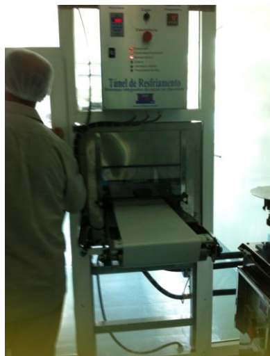
Figura 43: Processo de resfriamento do chocolate – Túnel de resfriamento
